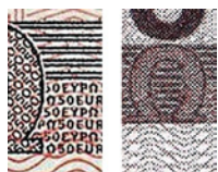
Рис. 2.5. Искажение микротекста при репрографическом воспроизведении
